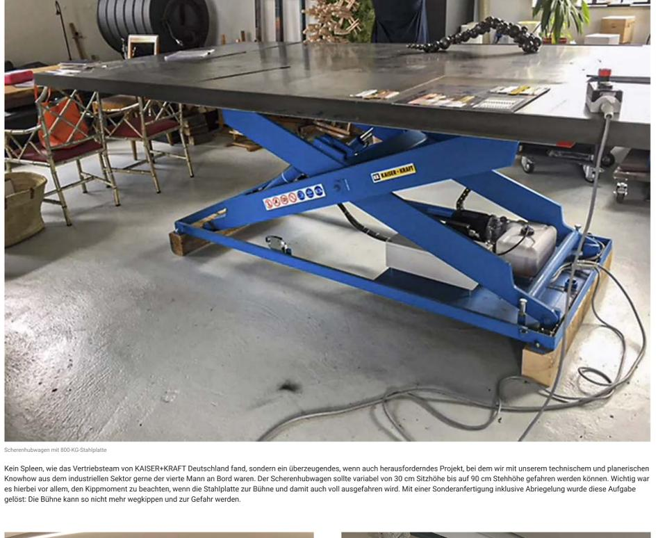
Scherenhubwagen mit 800-KG-Stahlplatte
